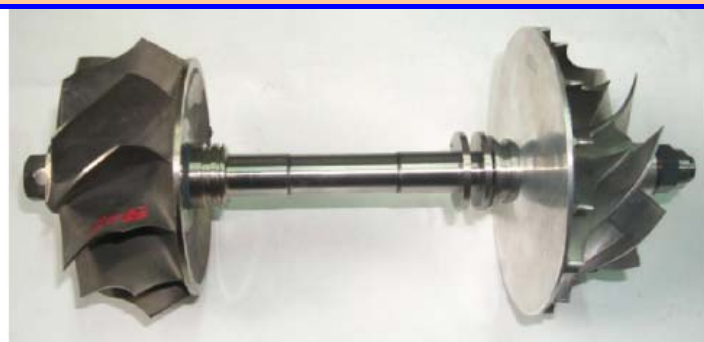
图 13 涡轮增压器转子结构图
