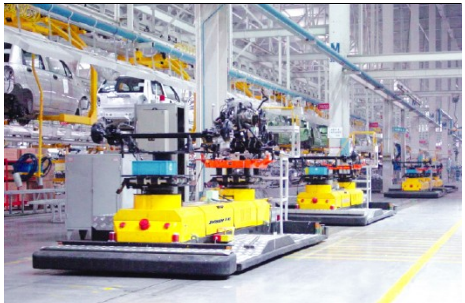
图表14：公司生产的汽车双举升AGV装配系统
