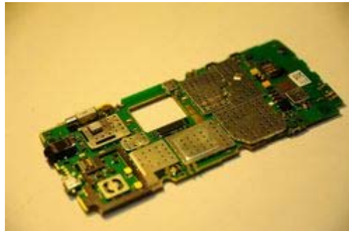
图 2: OPPO 智能机电磁屏蔽件
