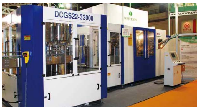
图表3：轻量化吹灌旋一体机实际图例及示意图
