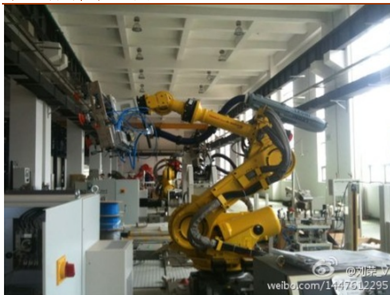
图18：调试中的搬运机器人
