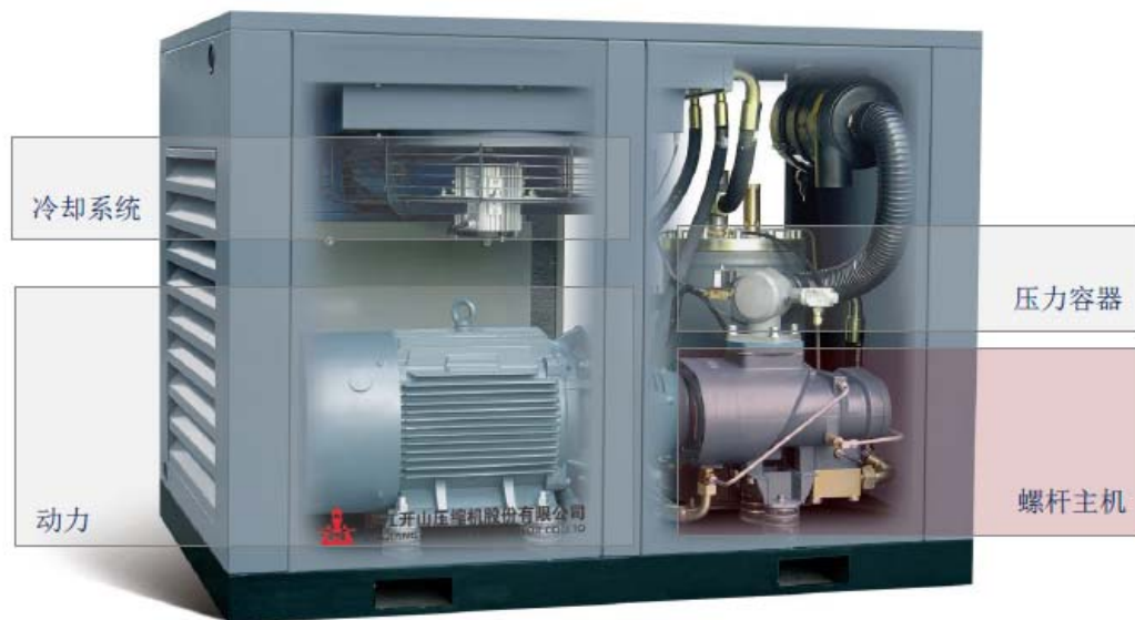
图 9：螺杆式空压机的组成
