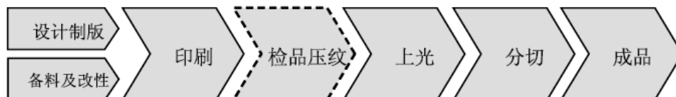
图3: 扑克牌生产流程图
