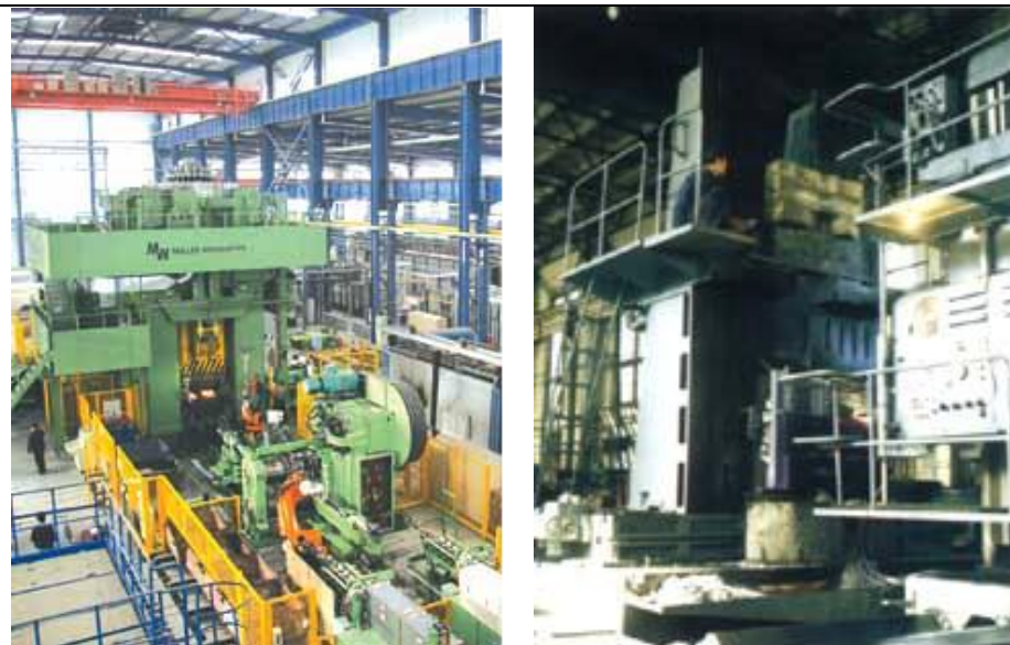
图 16：富成 1.6 万吨电动螺旋压力机精密锻造生产线及大靠模铣床
