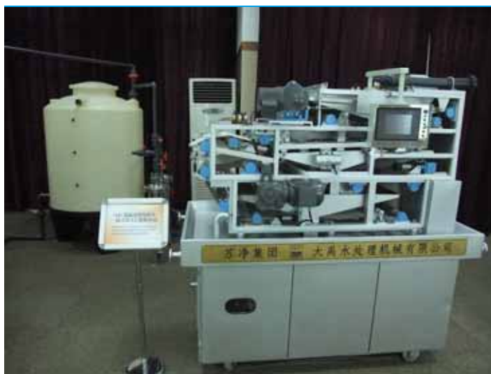
图表27：大禹一体式污泥脱水机
