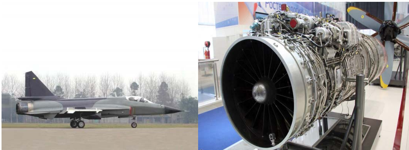
图 16：枭龙战斗机（左）和装备的俄制 RD-93 发动机（右）
