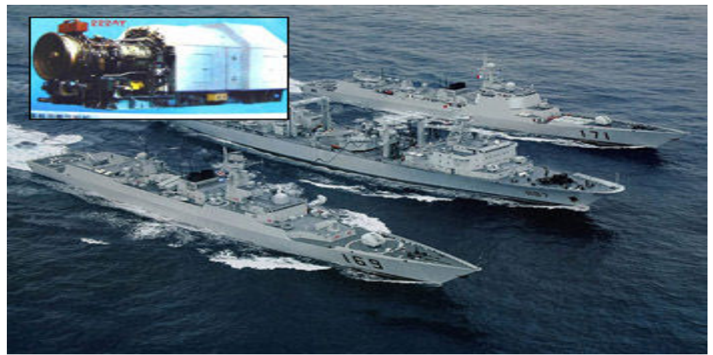
图 22：首批护航编队的 169 舰和 171 舰在亚丁湾执行护航任务，以及其配装的国产化 GT-25000 燃气轮机
