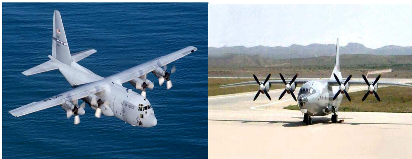
图 30：装配涡桨发动机的美国 C-130 运输机和我国运八运输机
