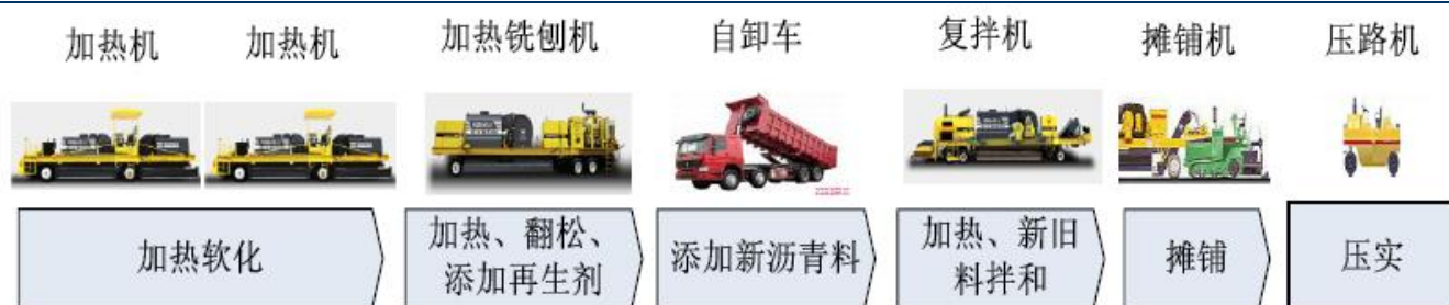
图5 大型沥青路面就地再生设备热再生机组
