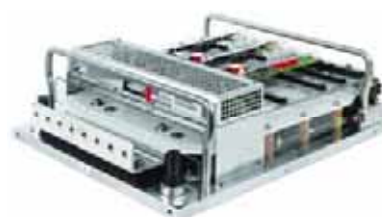
牵引变流器所用IGBT模块
