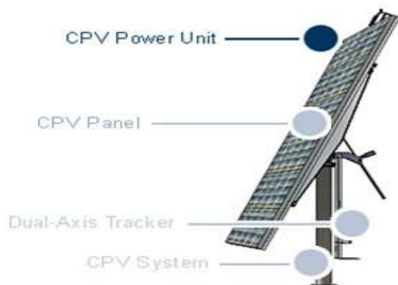
图 1：单个聚光太阳能发电系统
