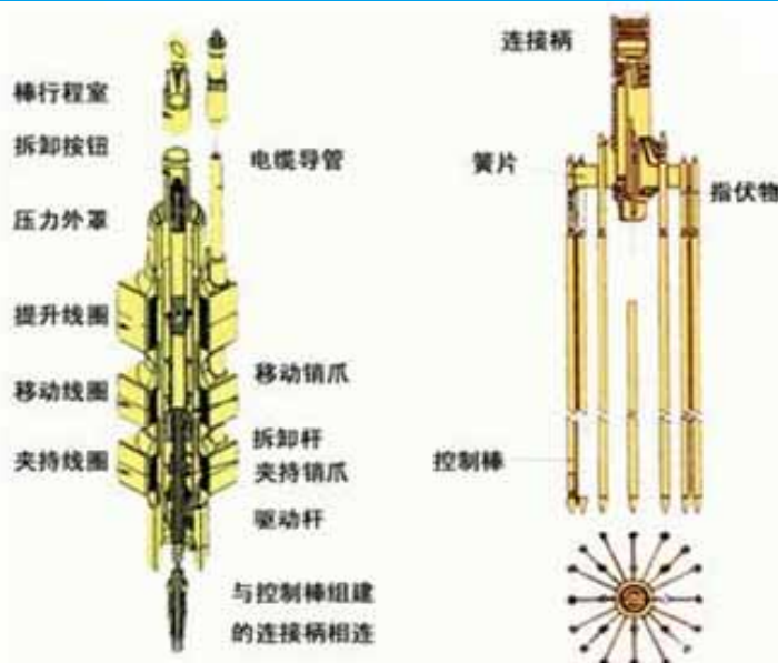
图表4：驱动棒控制装置的结构
