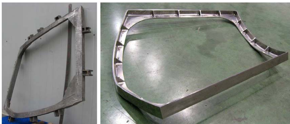
图 9：我国首架大型客机 C919 机头工程样机激光成形 Ti-6Al-4V 钛合金主风档窗框大型复杂机构件
