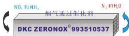
图表22 成都东方凯瑞公司蜂窝式火电脱硝催化剂示意图
