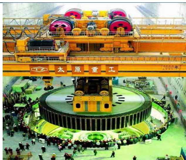
图15 1200吨水电站桥式起重机
