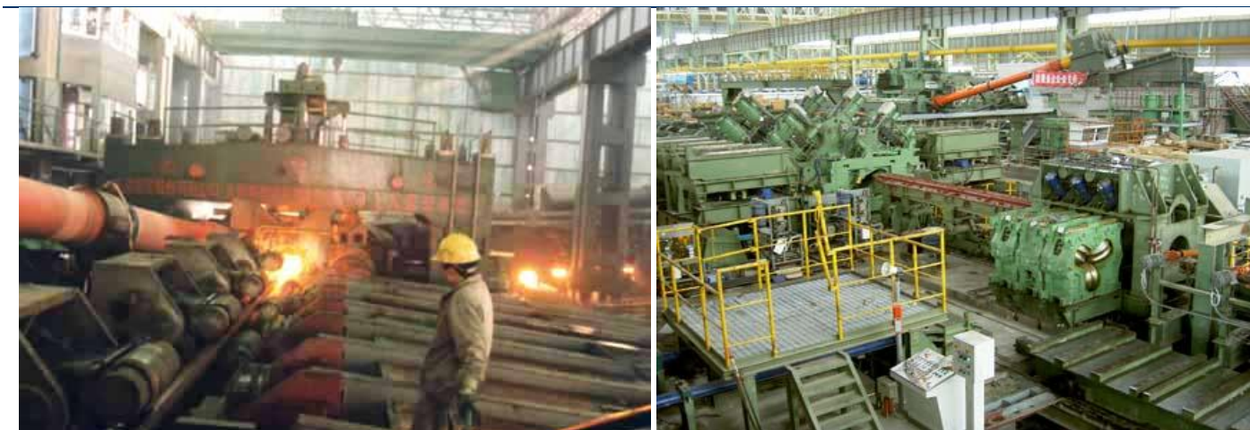
图 19 自主知识产权 \phi 340 连轧管机
