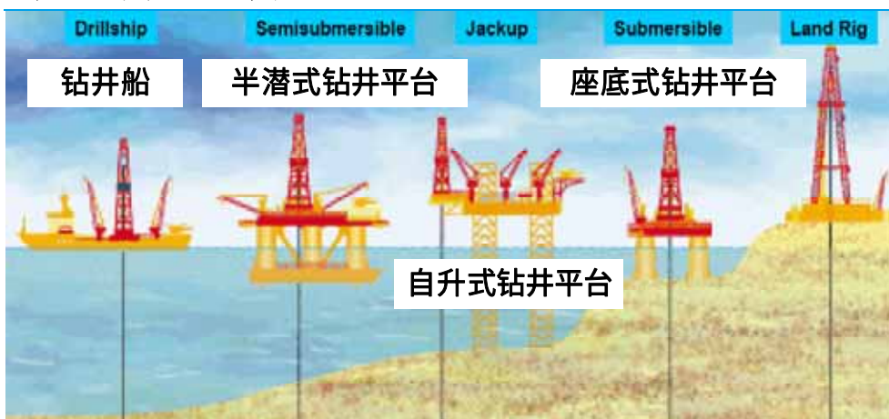
图表23：海洋石油钻井平台分类和图示
