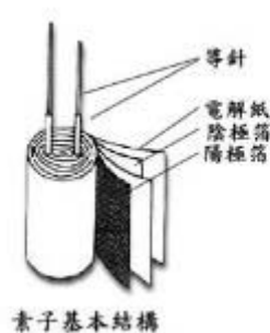
图 7、电解电容器种电极箔基本结构
