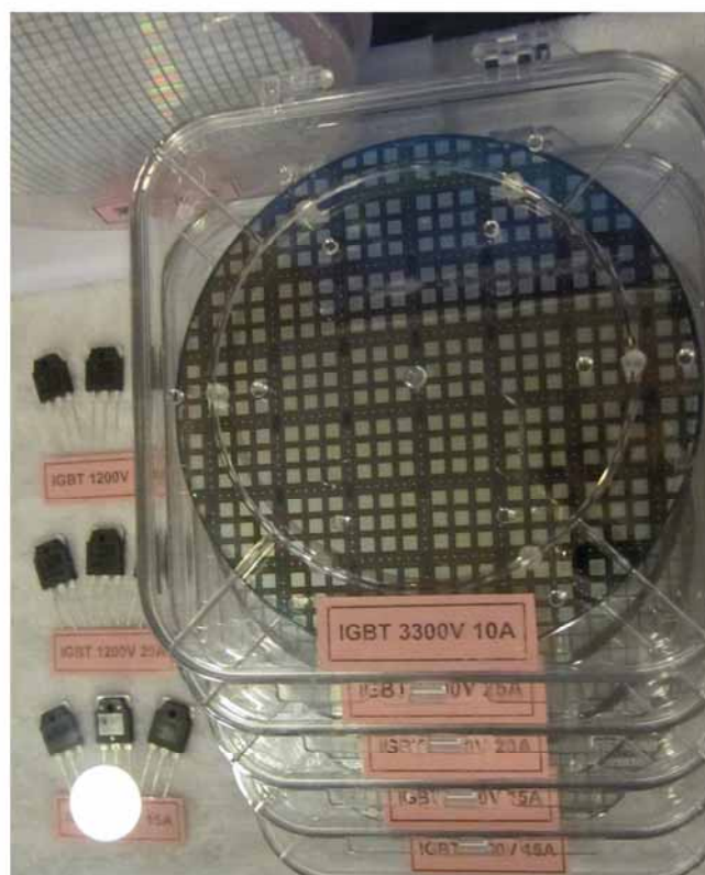
图 5 公司展示的 3300V/10A IGBT 样片：
