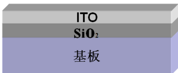
图 5: ITO 玻璃结构
