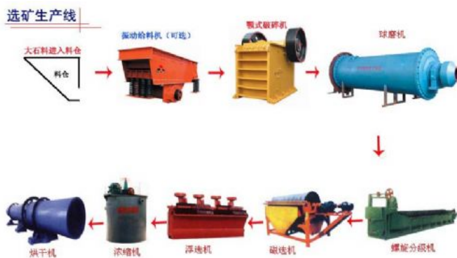
附图 1 磁选选矿生产线流程
