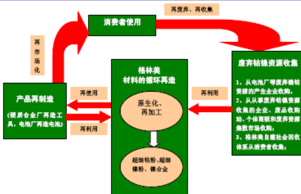
图 5：公司从废旧钴镍资源循环再造超细钴镍粉的循环模式
