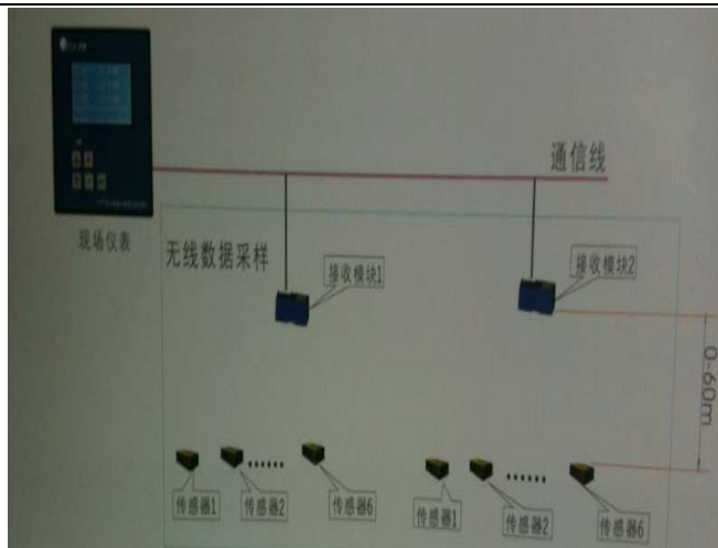
图 5：电力设备无线智能监控仪
