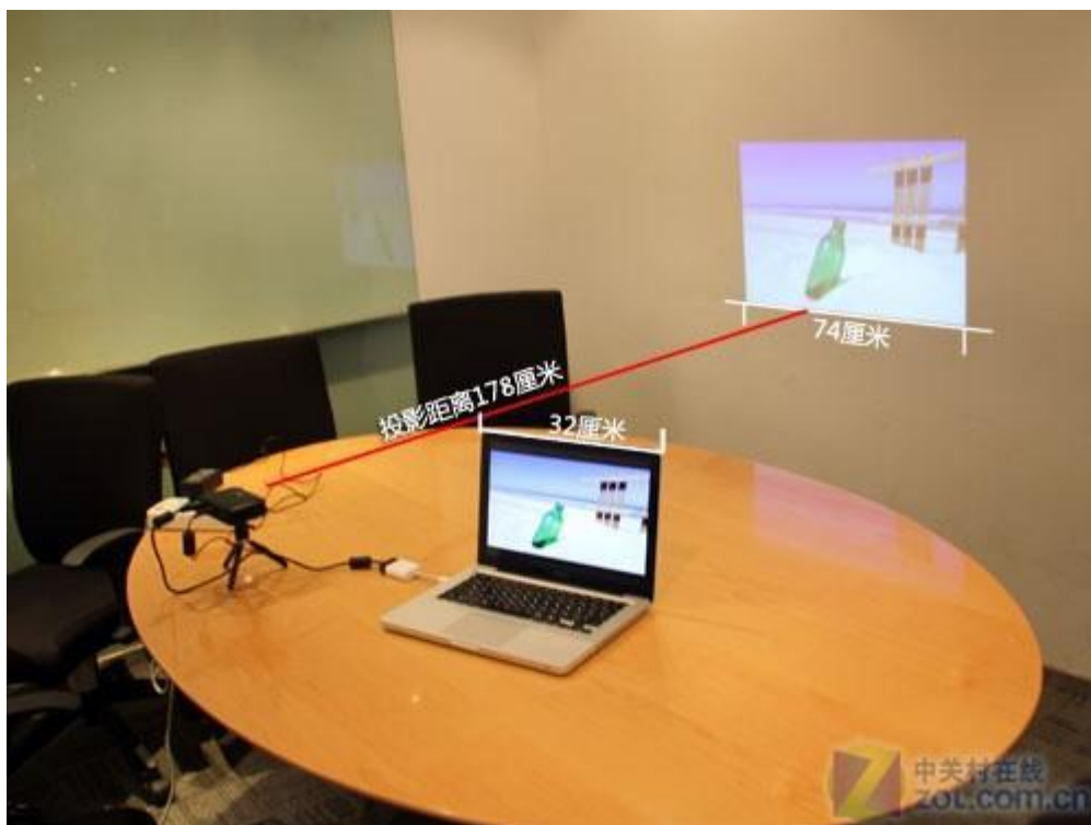
图 5 奥图码 PK301 外置模块（50 流明）在室内灯光下的投影效果
