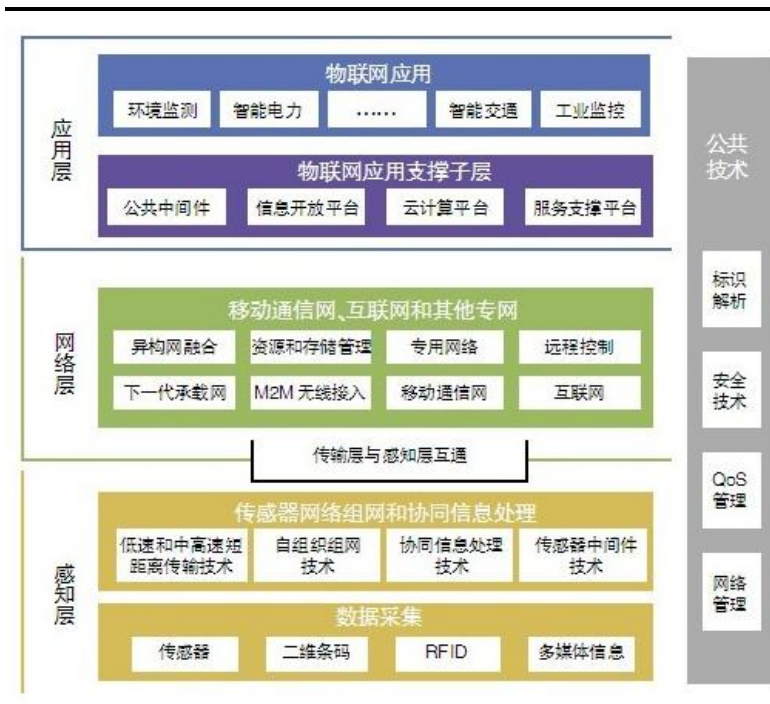
图表 7 物联网工作结构图
