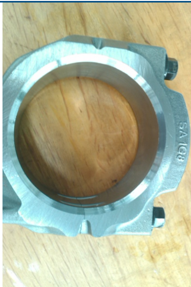
图 19： 公司生产的胀断连杆细节
