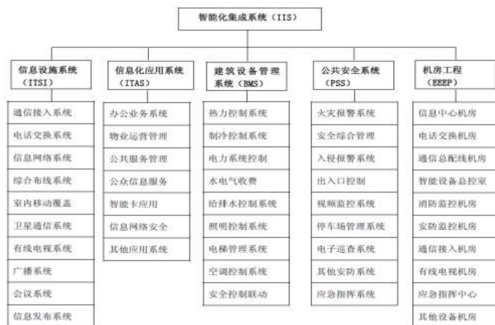
图 5：建筑智能化系统
