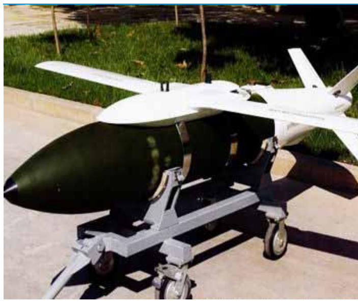
图表32：国产雷石6滑翔炸弹采用GPS制导，急需北斗来进行替换
