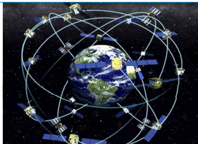
图表26：GPS 全球卫星定位系统由 24 颗卫星组成，定位快且覆盖全面
