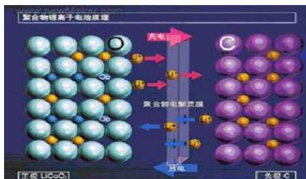
图表 10 锂电池工作原理
