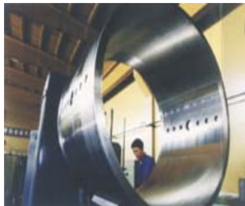
大型衬套正在制造中
