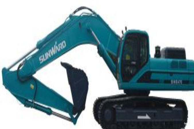
图 16、SWE470 大型挖掘机
