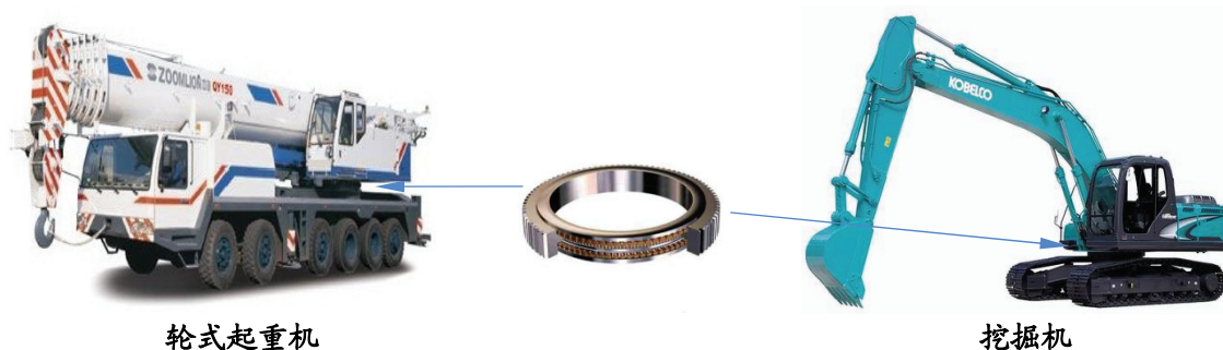
图 14: 回转支承产品在工程机械领域的应用
