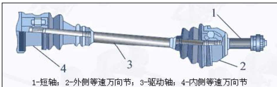
图 9 等速驱动轴产品结构示意图
