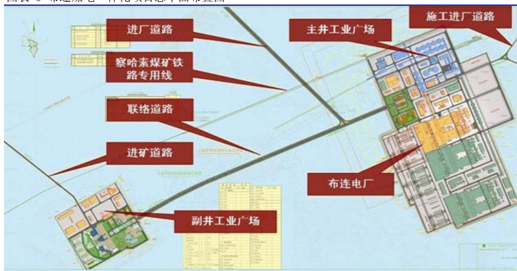
图表 3 布连煤电一体化项目总平面布置图
