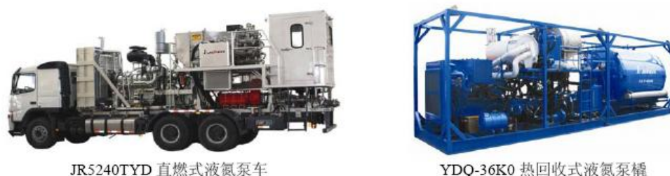
图 20：公司生产的液氮泵车
