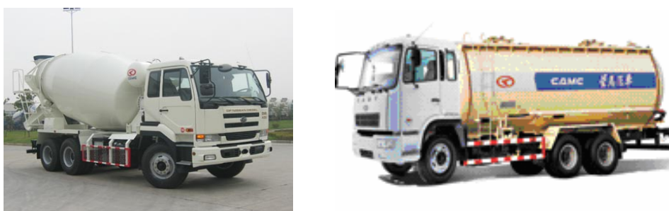
图 2：混凝土搅拌车和散装水泥运输车
