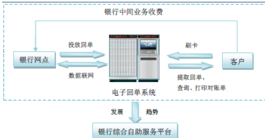
图 4：电子回单系统工作示意图
