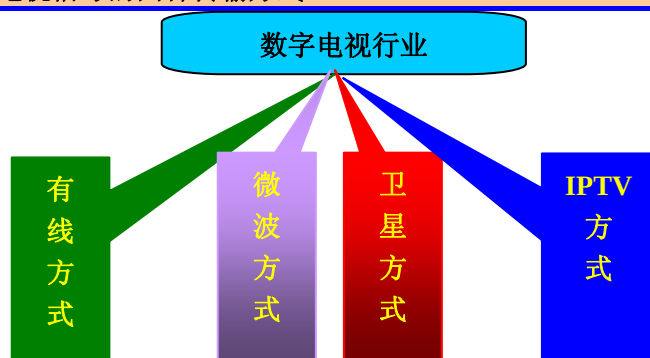
图 5 数字电视信号的四种传输方式
