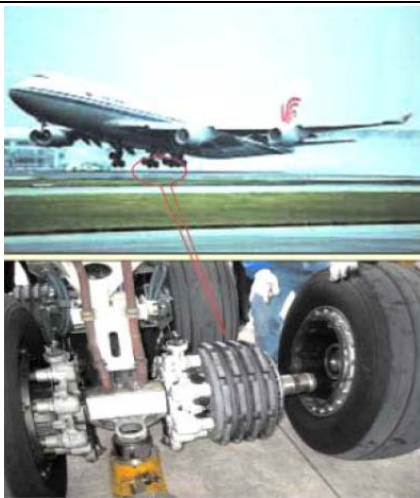
图 1：飞机刹车副用于飞机制动
