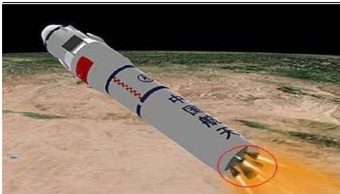
图 9：炭/炭复合材料用于火箭发动机喷管
