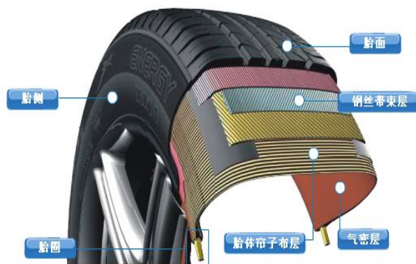
图3. 子午线轮胎结构
