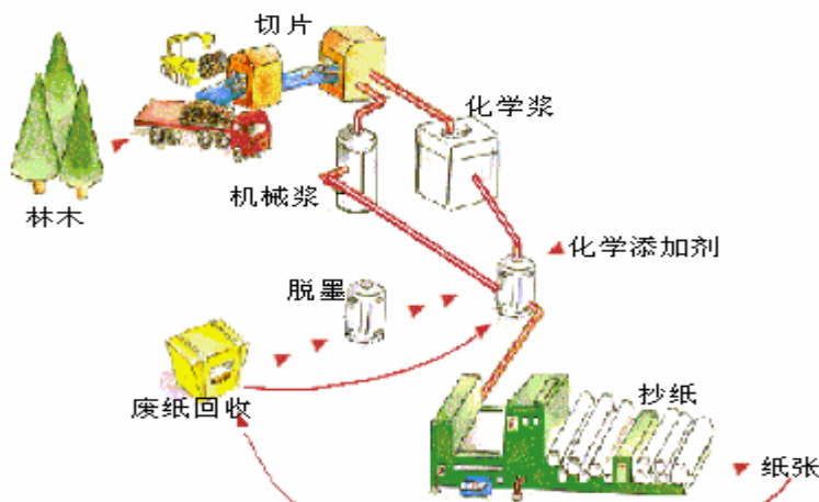
图 3：造纸工艺流程示意图
