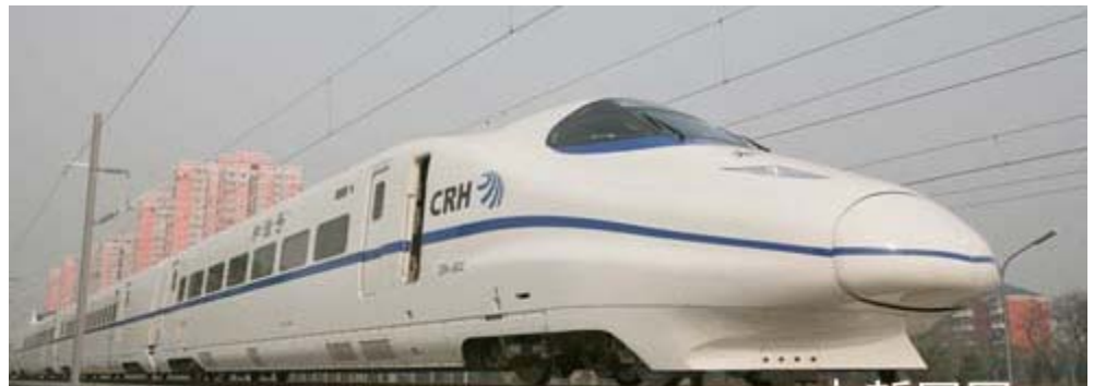
图 15：南车青岛四方生产的时速 300 公里动车组
