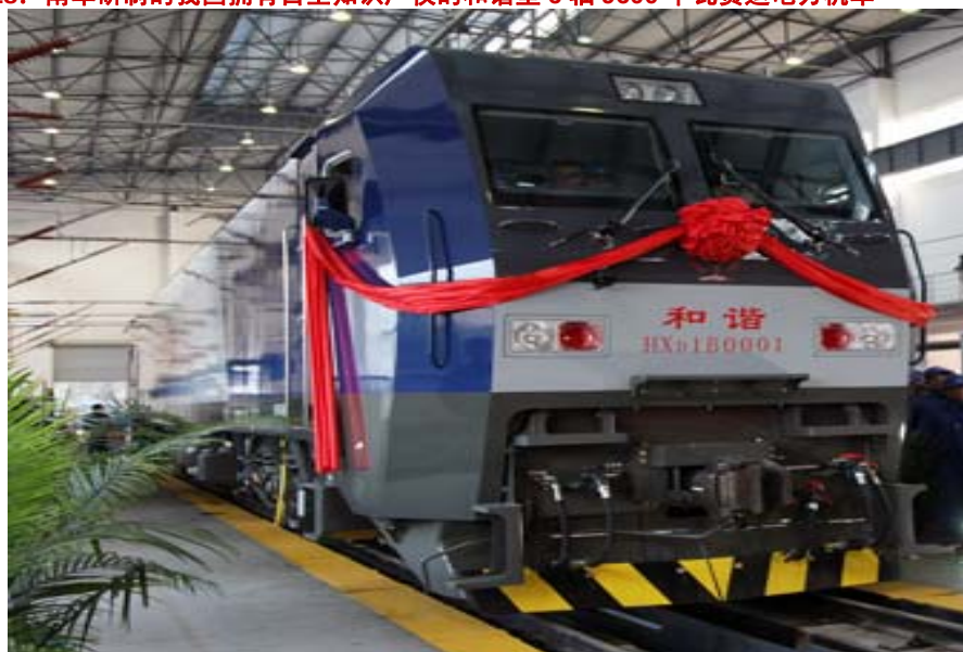
图 18：南车研制的我国拥有自主知识产权的和谐型 6 轴 9600 千瓦货运电力机车
