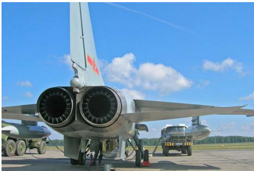
图24：装配“秦岭”发动机的改进型飞豹战机
