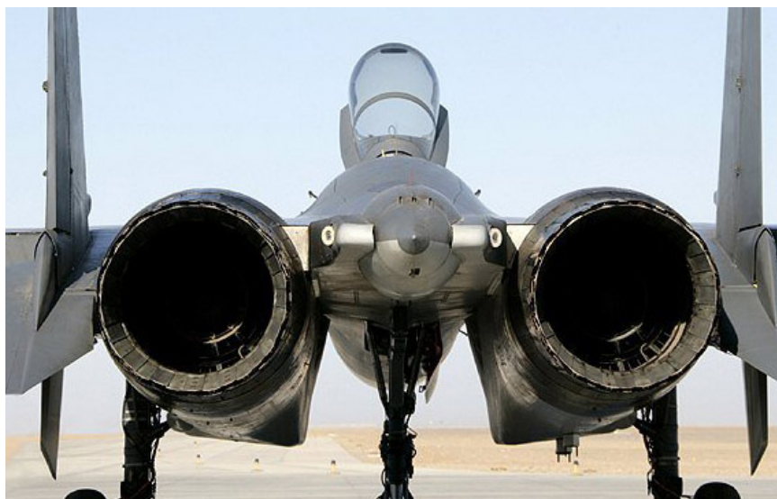
图25：装配“太行”发动机的歼-11战机
